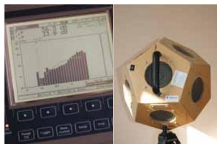
Die schalltechnische Messung durch das Ingenieurbüro Park + Dr. Rath, Dipl.-Ing.(FH) Philipp Park und Dr. Wolfgang Rath, bestätigte ein sicheres Erreichen des erhöhten Schallschutzes nach DIN 4109, Beiblatt 2.
