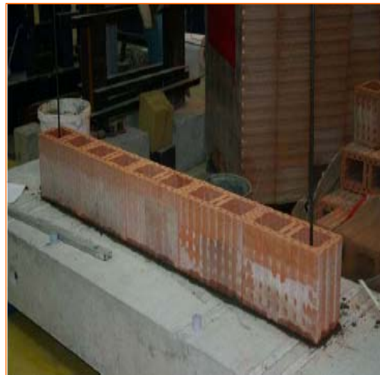
Bild 2: Prüfkörper aus Füllziegeln mit Randbewehrung
